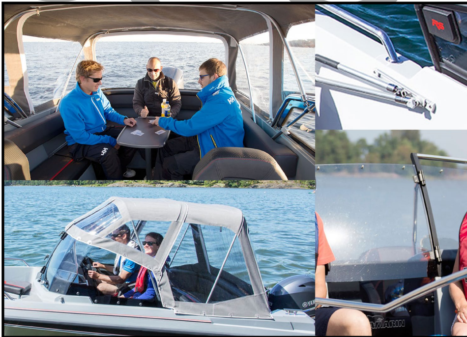
Kuva 9. Bow rider -mallin veneiden kattokuomuja ja nepparit.
