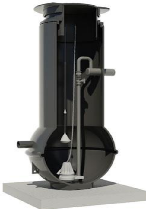
Kuva 7. Kiinteistöpumppaamo perusvesille. (Talokaivo.fi)
