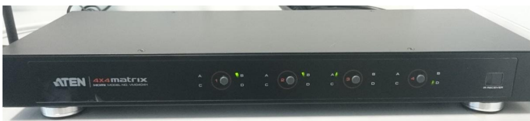
KUVA 18. Aten HDMI-matriisin etupaneeli (Ruotsalainen, 2016-02-18.)
