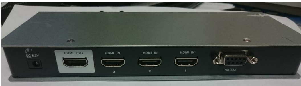
KUVA 16. Aten HDMI-valitsimen takapaneeli (Ruotsalainen, 2016-02-18.)
