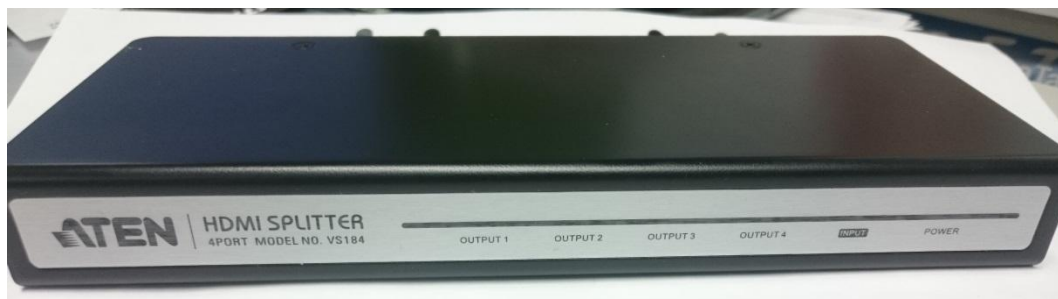
KUVA 14. Aten HDMI jakaja etupaneeli (Ruotsalainen, 2016-02-18.)
