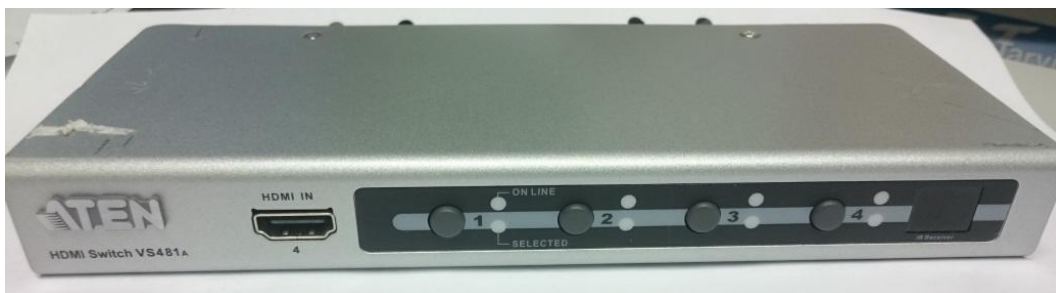
KUVA 17. Aten HDMI-valitsimen etupaneeli (Ruotsalainen, 2016-02-18.)
