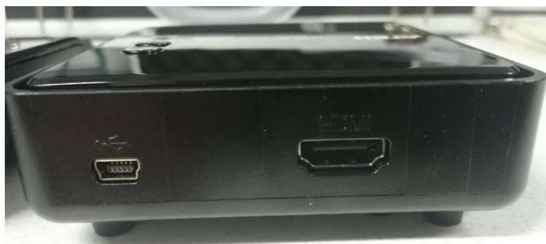
KUVA 29 Aten VE809 HDMI -vastaanottimen liittimet (Ruotsalainen, 2016-02-18.)
