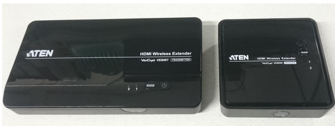
KUVA 27. Aten WHDI langaton HDMI-lähetin ja vastaanotin (Ruotsalainen, 2016-02-18.)
