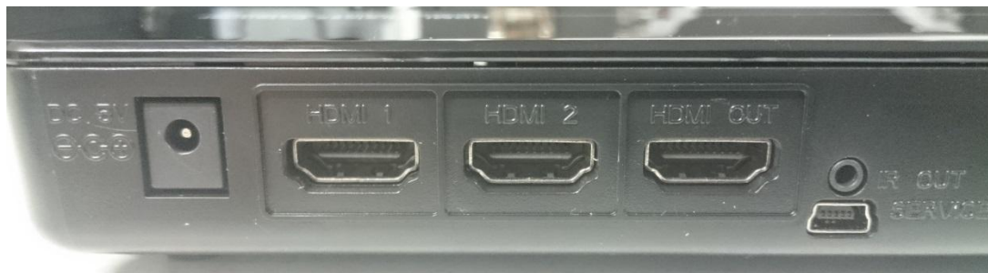
KUVA 28. Aten VE809 HDMI -lähettimen liittimet (Ruotsalainen, 2016-02-18.)
