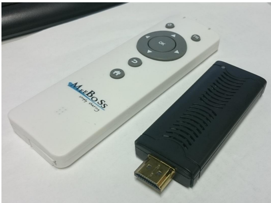
KUVA 7. Miracast vastaanotin ja sen kaukosäädin (Ruotsalainen, 2016-02-18.)
