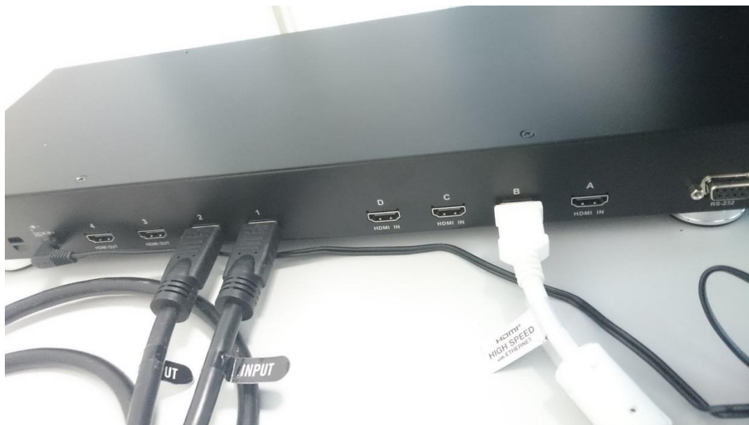
KUVA 19. Aten matriisin takapaneeli, jossa on liittimet (Ruotsalainen, 2016-02-18.)
