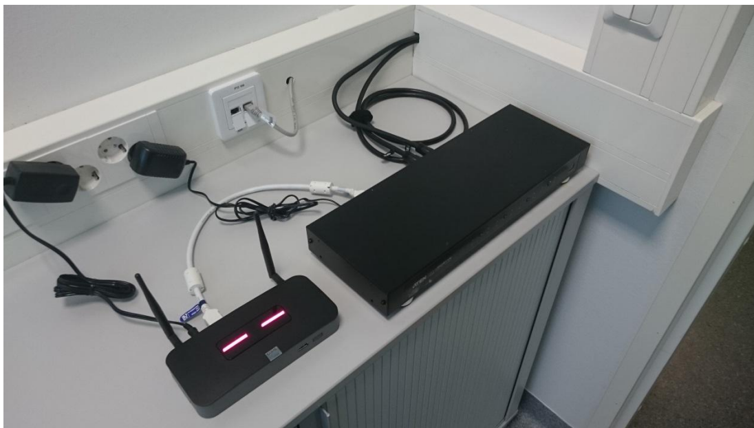
KUVA 30. Barco CSM-1 ja Aten matriisi VM-0404H asennettuna Istekin neuvottelutilaan (Ruotsalainen, 2015-02-24.)
