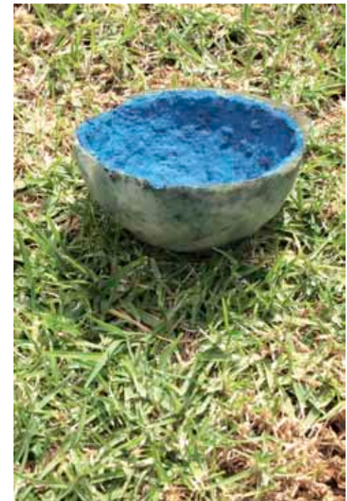
Kuva 14. Paperimassavarjostin, johon on lisätty sinistä väriainetta.
