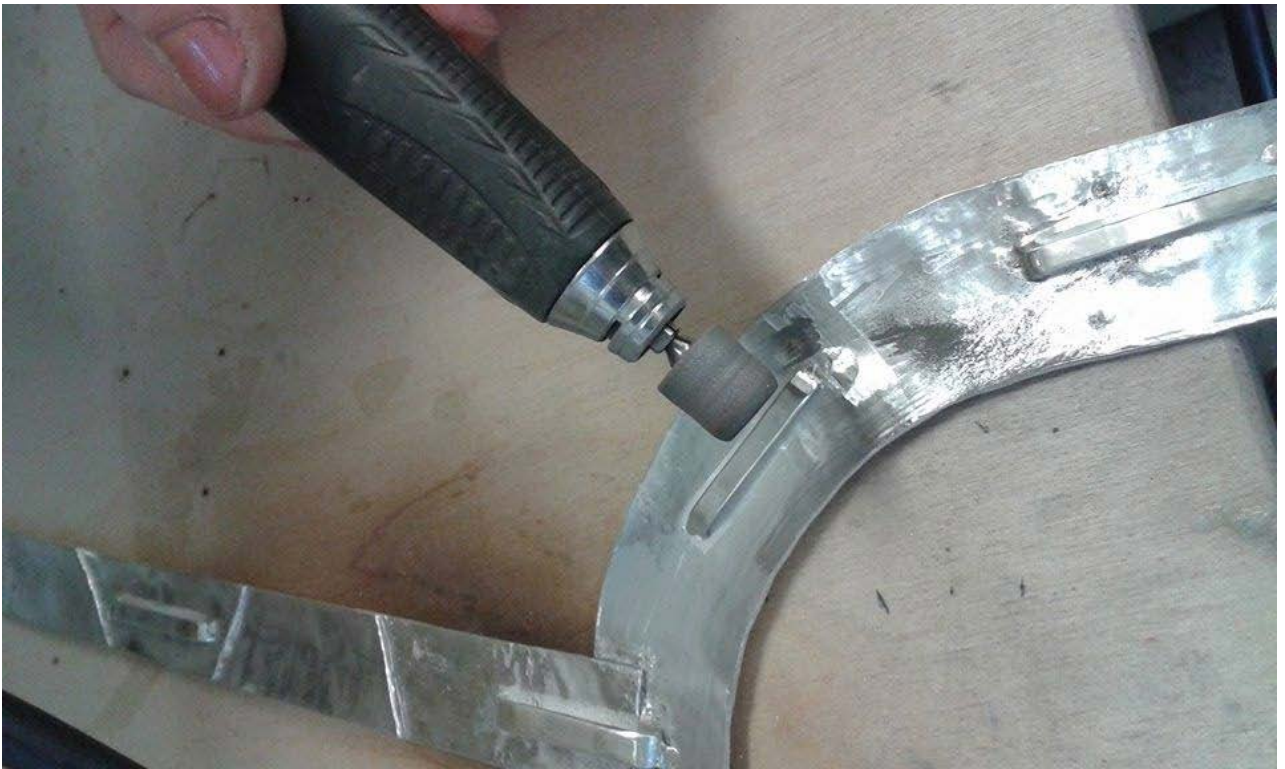
KUVA 8. Taustapuolelle juotetut lenkkielementit ja pinnan viimeistely mikroporalla (Tikkanen, 2016)
