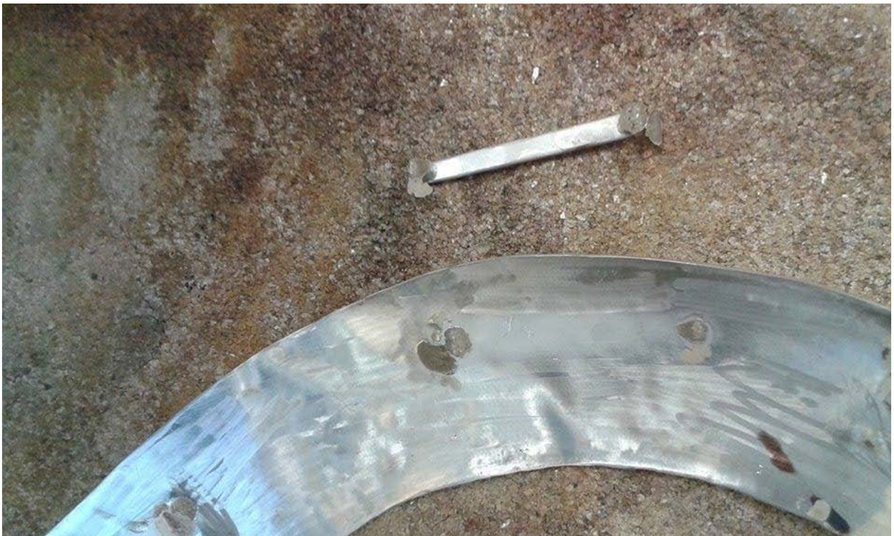
KUVA 9. Irronnut kylmäjuotos (Tikkanen, 2016)
