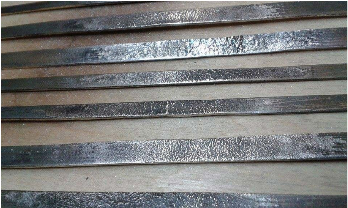
KUVA 11. Skrympatut lisäkappaleet (Tikkanen, 2016)
