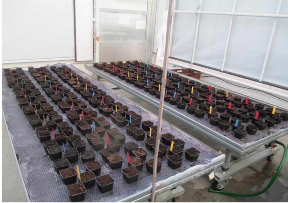
Kuva 1. Fytotoksisuuskokeen koeasetelma, jossa kurkun, ohran ja vihanneskrassin koeruudut erottuvat erivärisillä nimisäleillä. Koeruutu sisälsi viisi Vefi-ruukua.
