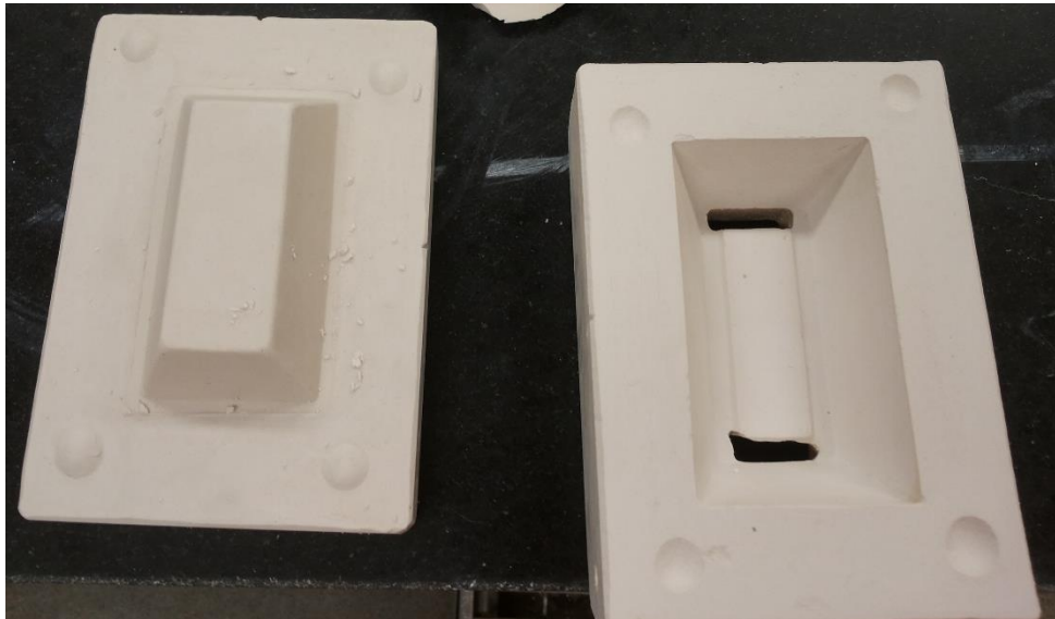
Kuva 30. Soijakastikelautasen kipsimuotti, vasemmalla alaosa ja oikealla päällisosa, jossa näkyy valaukot
