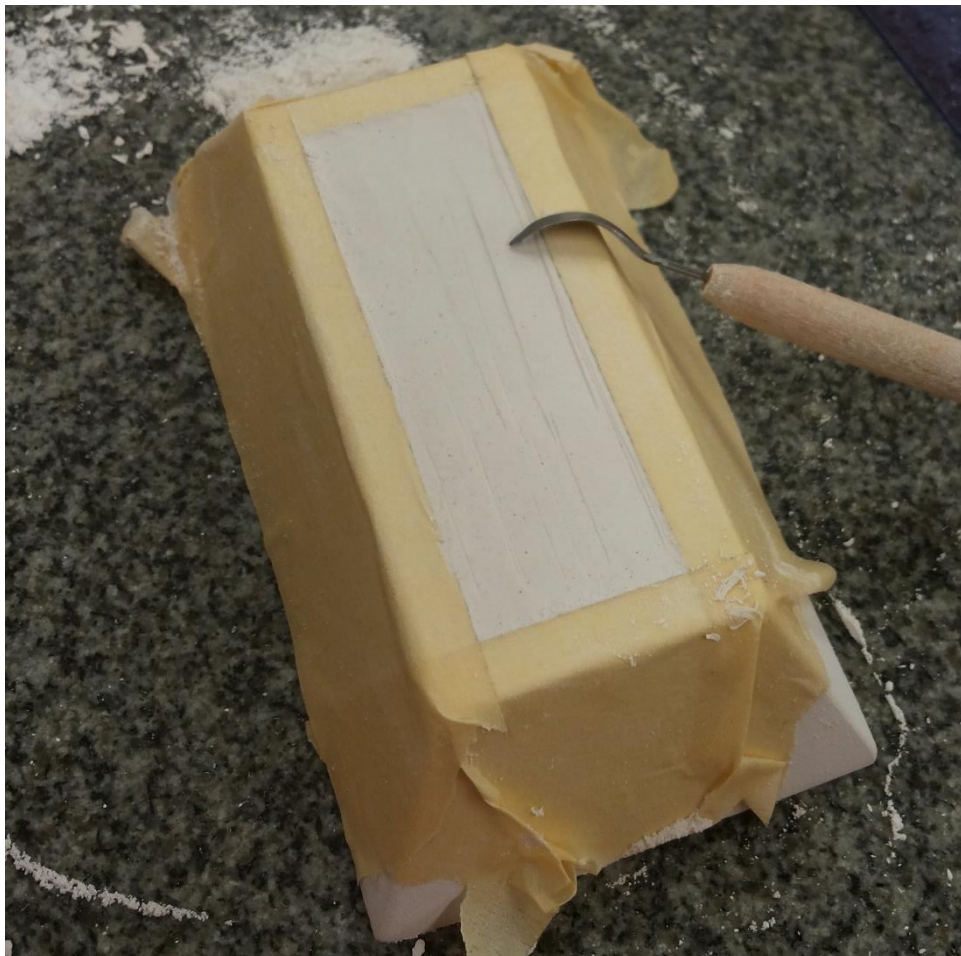
Kuva 29. Soijakastikelautasen mallineen jalkarenaan kaiverrusta
