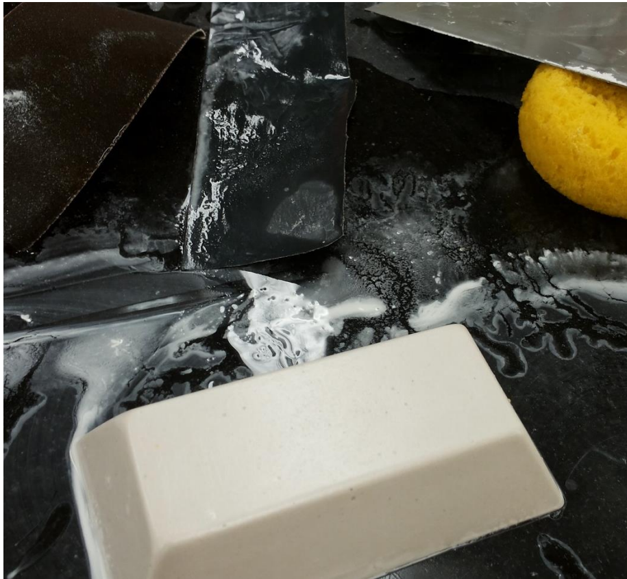
Kuva 27. Hiottu soijakastikelautasen mallineen sisätukikappale ja hionta työssä apuna käytetyt työvälineet: kaksi eri hiontapaperia, metallinen sikli ja sieni
