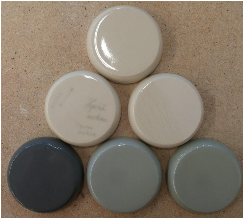
Kuva 21. (Luetaan ylhäältä alas vasemmalta oikealle) Kontrolli, alilasitekynä testit, suomukuvio, massa 1, massa 2 ja massa 3 -koepalat
