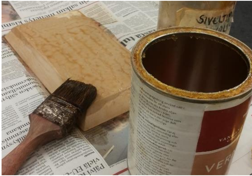
Kuva 28. Ruokalautasen mallineen sisätukikappaleen vernisointi (sama toistettiin soijakastikelautasen sisätukikappaleen mallineen kanssa)
