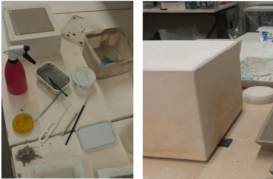
Kuva 31. Vasemmalla: Valamista ja siinä käytettäviä apuvälineitä. Oikealla: Keittolautasen muotti väärin päin
