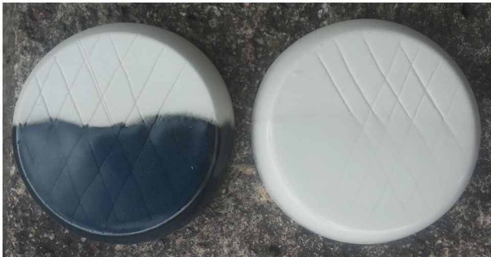
Kuva 23. Mustapigmenttinen lasite ja valkopigmenttinen lasite koepalat
