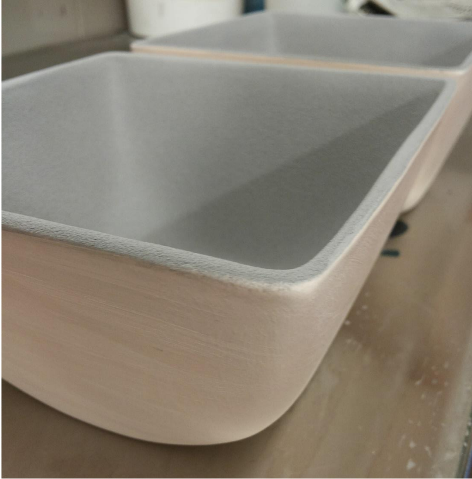
Kuva 33. Sisäpinnaltaan ruiskulasitetut keittolautaset
