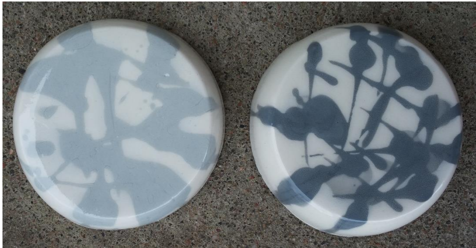
Kuva 22. Roiskekuvio koepalat (vasenmalta oikealle): massa 2 ja massa 1
