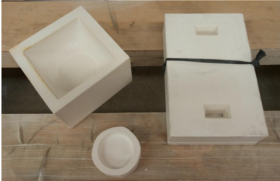
Kuva 3. Keittolautasen kipsimuotti (vasemmalla), ruokalautasen kipsimuotti (oikealla) ja keskellä on testipalojen kipsimuotti (ks. 4 Pinnansuunnittelu)
