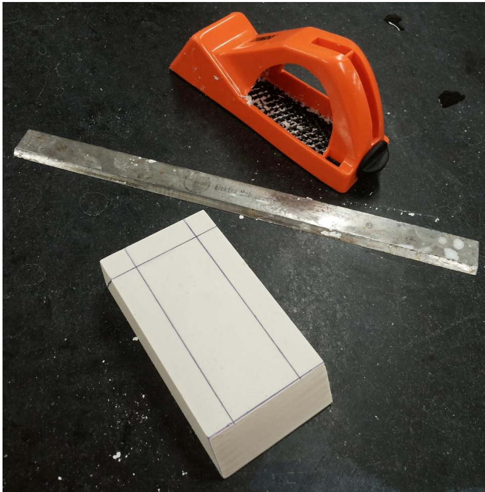
Kuva 26. Kuvassa raspi, metallinen terä, jolla on helppo tasoittaa kipsin pintaa, ja soijakastikelautasen mallineen sisätukikappale (kipsinen suorakaide)
