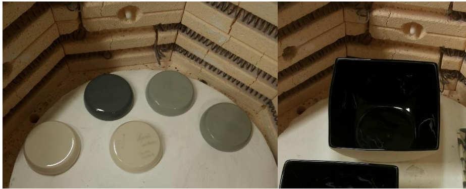
Kuva 34. Vasemmalla: koepalat uunissa. Oikealla: Lautaset samassa uunissa kuin koepalat olivat
