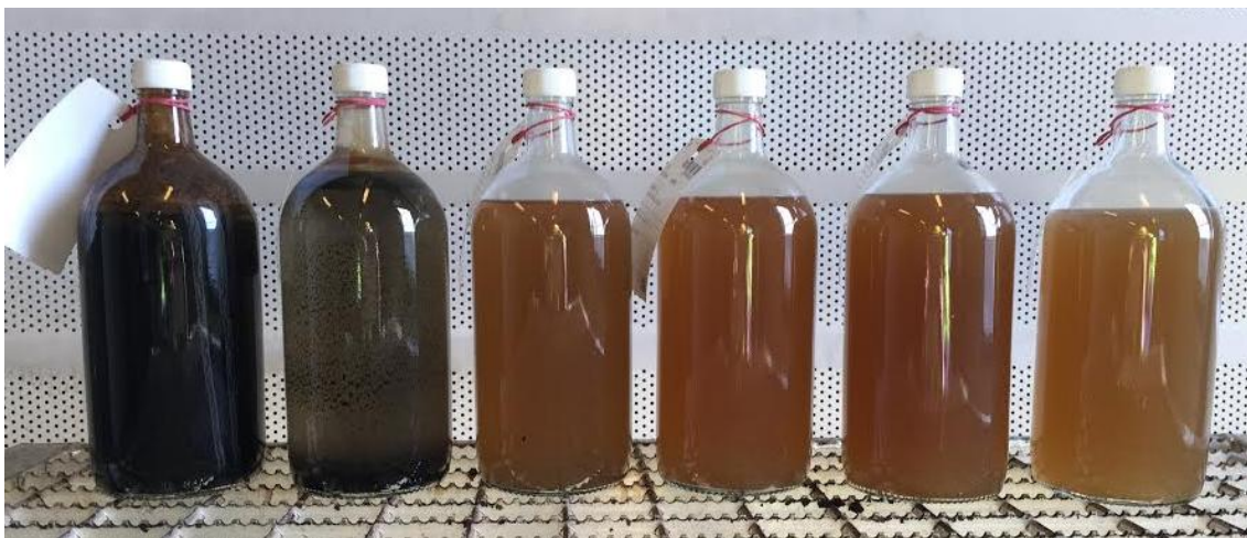
Kuva 18. Pullonäytteet neljänneltä koeajopäivältä. Vasemmassa laidassa syöttönäyte ja loput viisi päivän aikana kerättyjä rejektinäytteitä polymeerimäärän noston mukaisessa järjestyksessä (0,3–1,1 m 3 /h).
