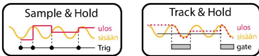
Kuva 5. Sample & Hold ja Track & Hold
