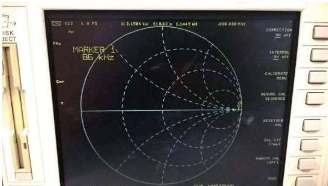
Kuva 25. Oma muunnin S22, 8753E Network Analyzer HP.
