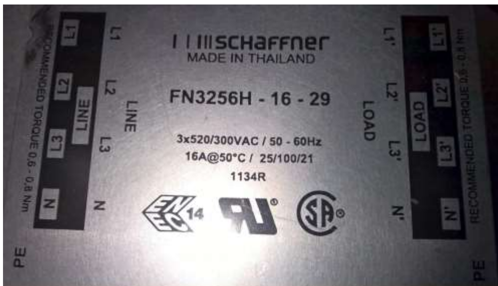
Kuva 7. Schaffner-suodatin ja tyyppikilvessä olevat testitalojen merkinnät.
