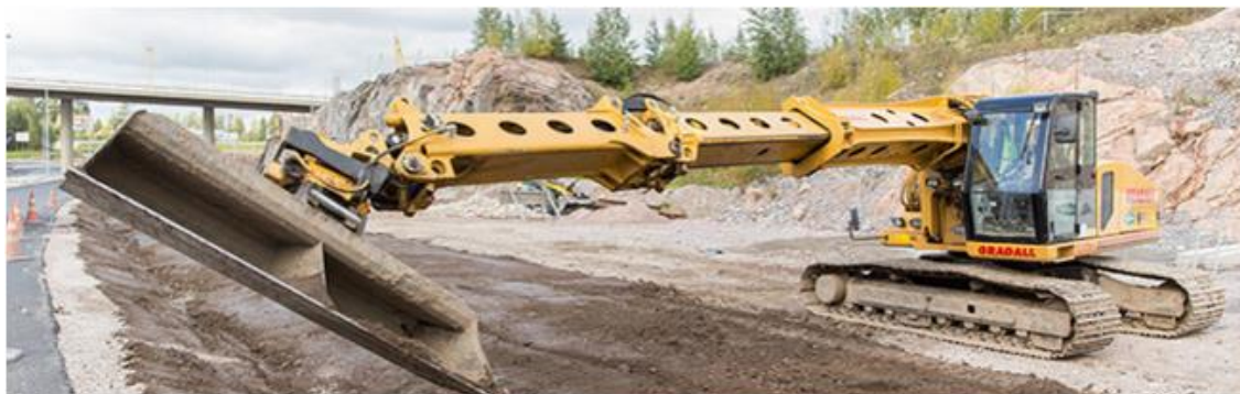
Kuva 23 Gradall varustettuna 2.4 m jatkopuomilla (Tieluiska 2016)
