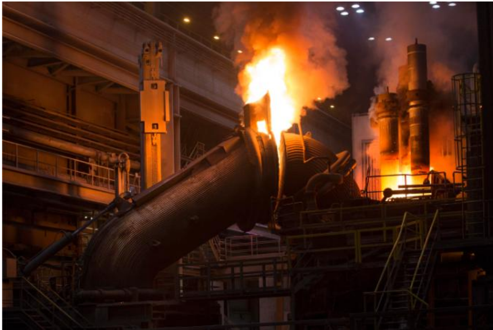
Kuva 2. Teräsken sulatus käynnissä (Vallo 2016)
