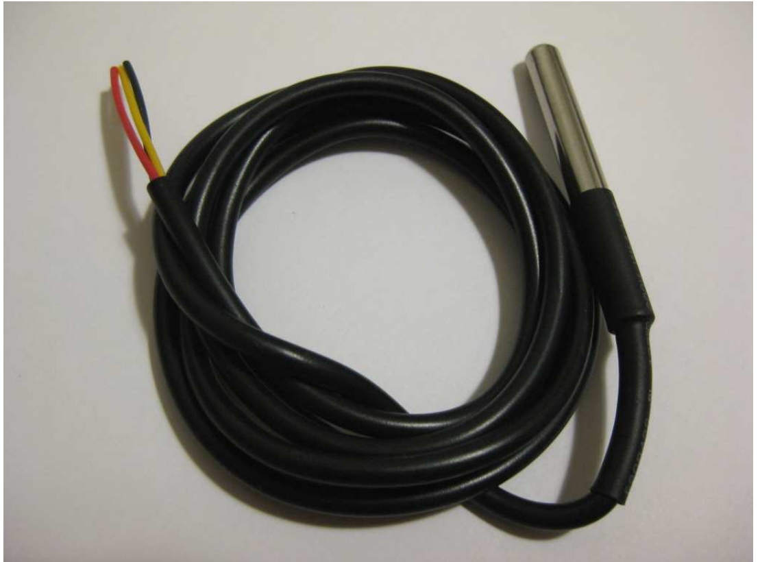
Kuva 11. Kuvassa oleva lämpösensori on vedenkestävä
