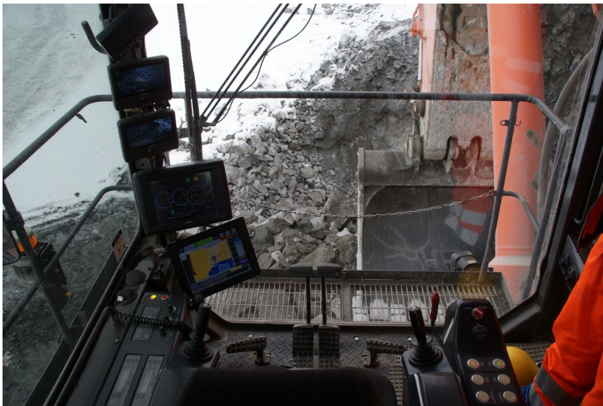
KUVA 9. Lastauskoneen Hitachi EX 2600-6 ohjaamo. Jigsaw monitori alimpana. (Vitri 2016-02-25)
