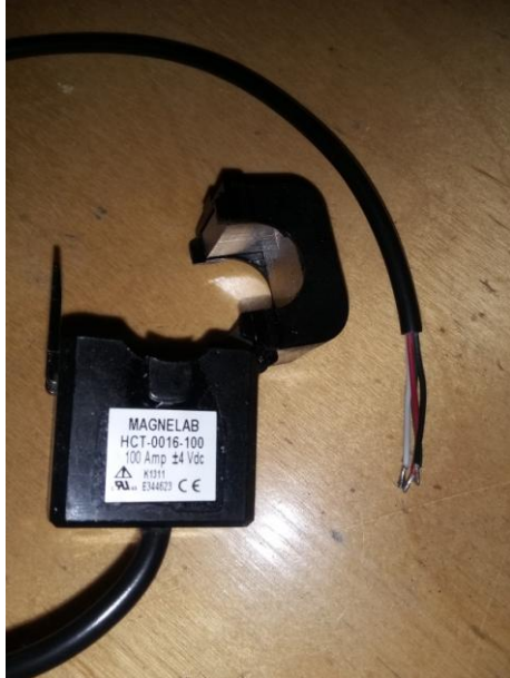
Kuva 9. Virran mittaamiseen käytetty Hall-anturi rengassydän avattuna
