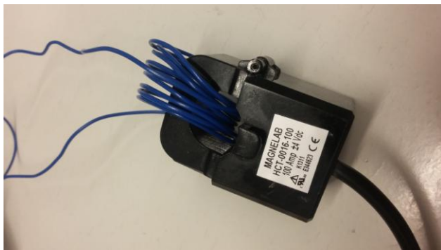
Kuva 10. Anturin rengassydämen ympäri kierretty johto
