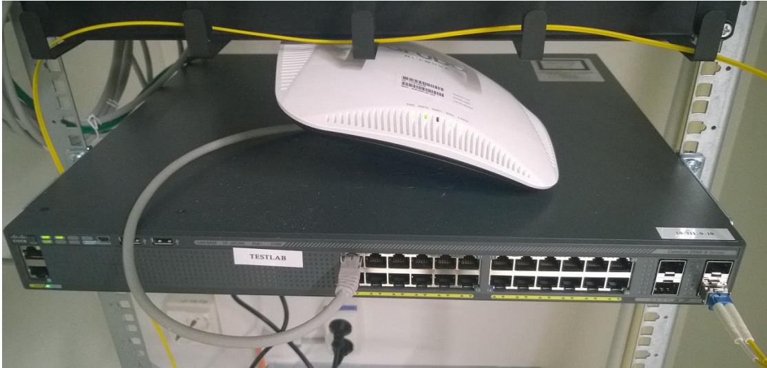
KUVIO 5: Cisco 2960X ja Aruba IAP-225, ensiasennus ja konfiguraation testaus
