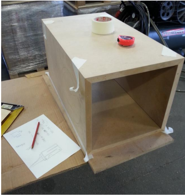
KUVA 16. Bassokotelon sivuseinien mitoitusta
