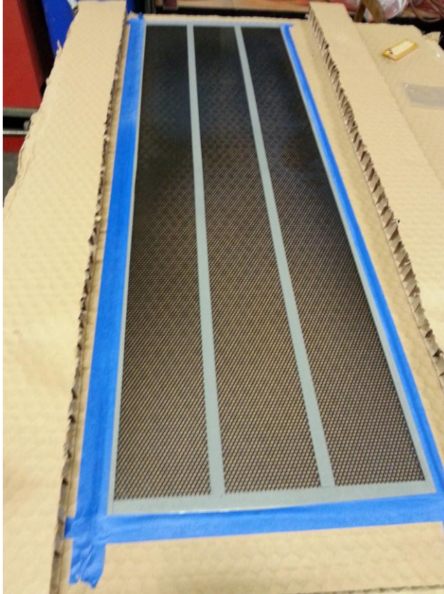
KUVA 11. Kalvo kiinnitettynä toiseen staattorilevyyn ja valmiina pinnoitettavaksi Licron Crystal –suihkeella
