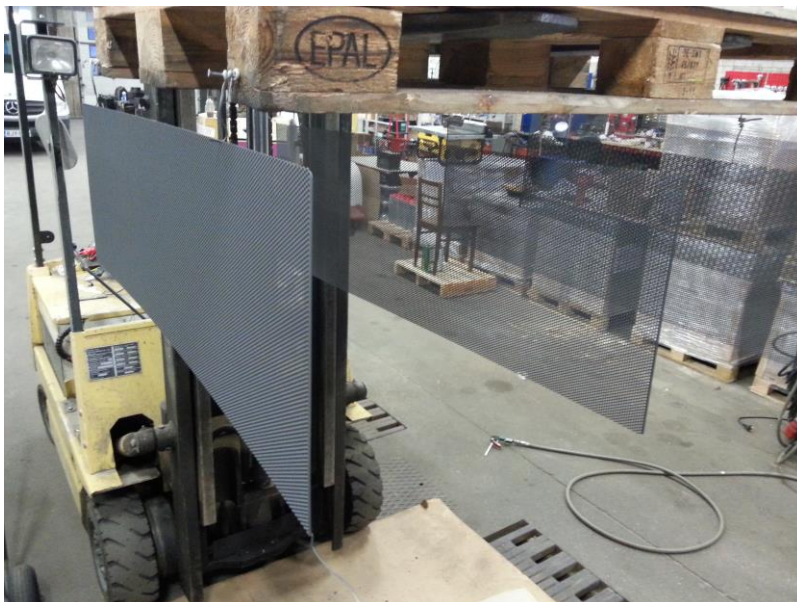
KUVA 7. Staattorilevyt ripustettu maalausta varten
