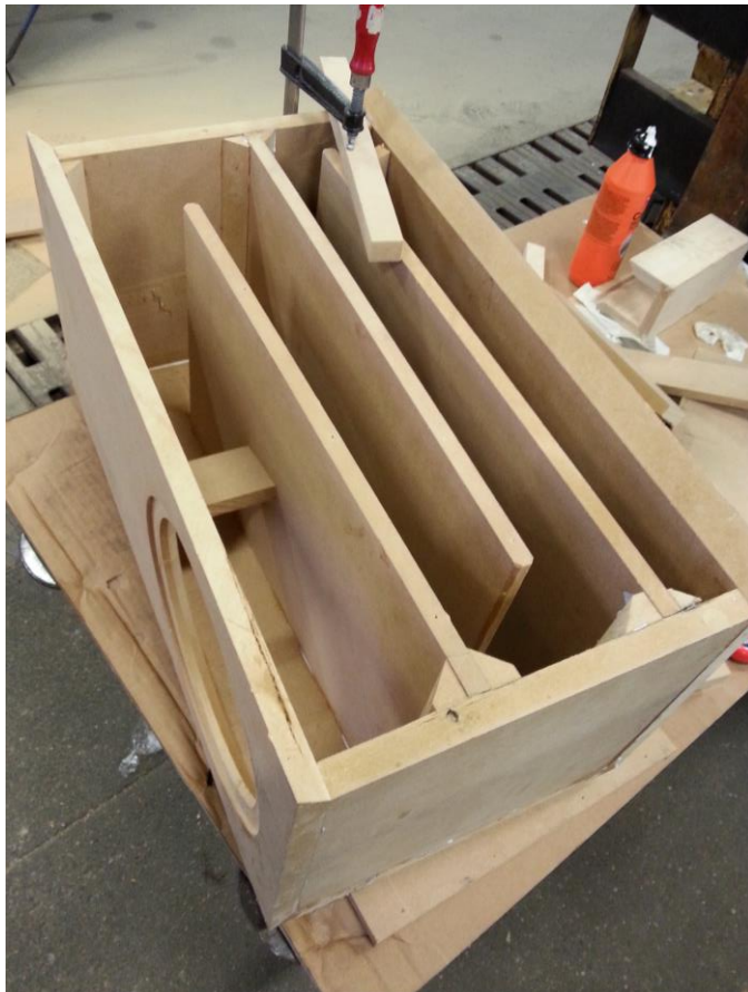
KUVA 17. Basso-osan transmissiolinjan sisäinen rakenne
