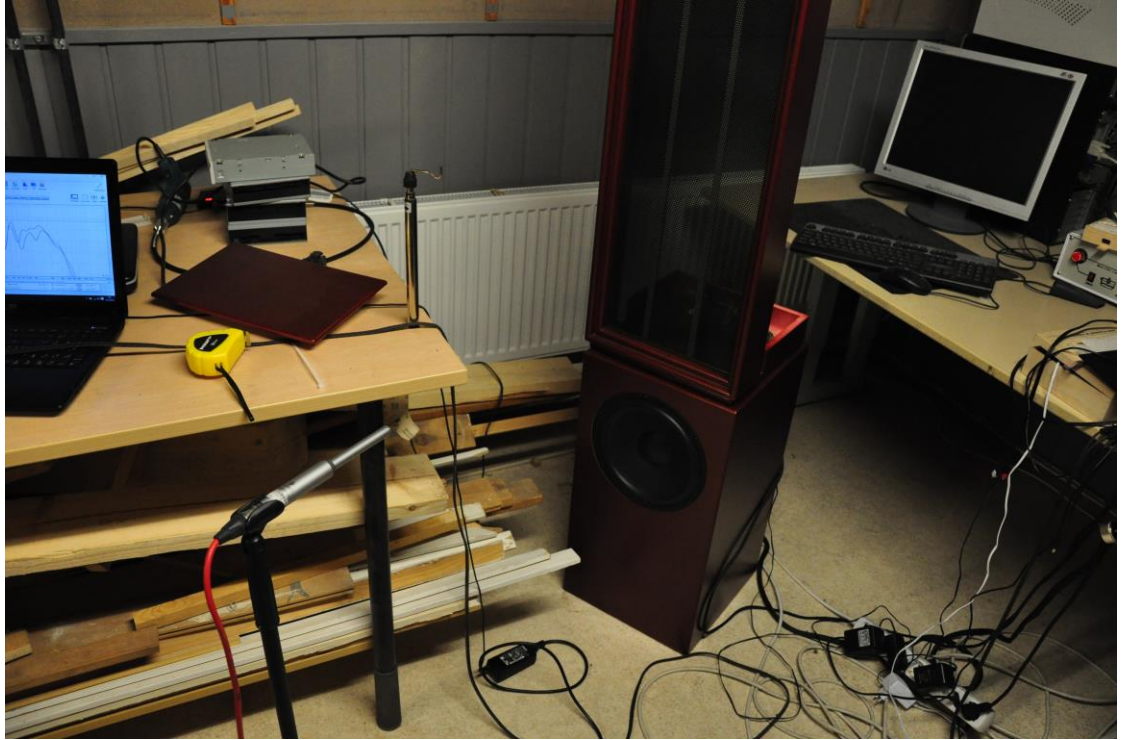
KUVA 26. Taajuusvasteen mittauslaitteisto ja mittusjärjestely
