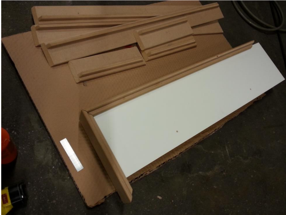
KUVA 13. Sähköstaattisen elementin tukikehikon kasaus
