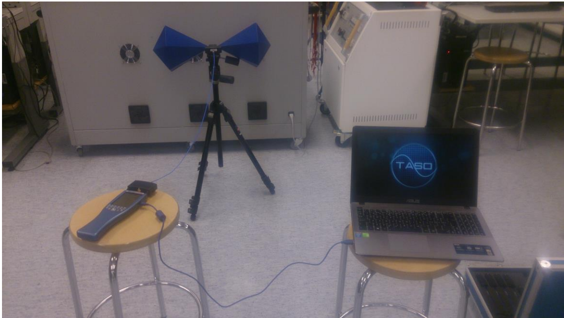
Kuva 11. Tyypillinen mittauskoonpano. BicoLOG antennilta tulee raakadata koaksiaalikaapelia pitkin vahvistimen kautta analysaattorille, josta käsitelty data siirretään usb-johtolla tietokoneelle.
