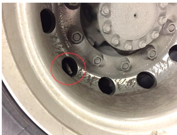
Kuva 16. Paripyörän sisemmän renkaan venttiilin jatke.
