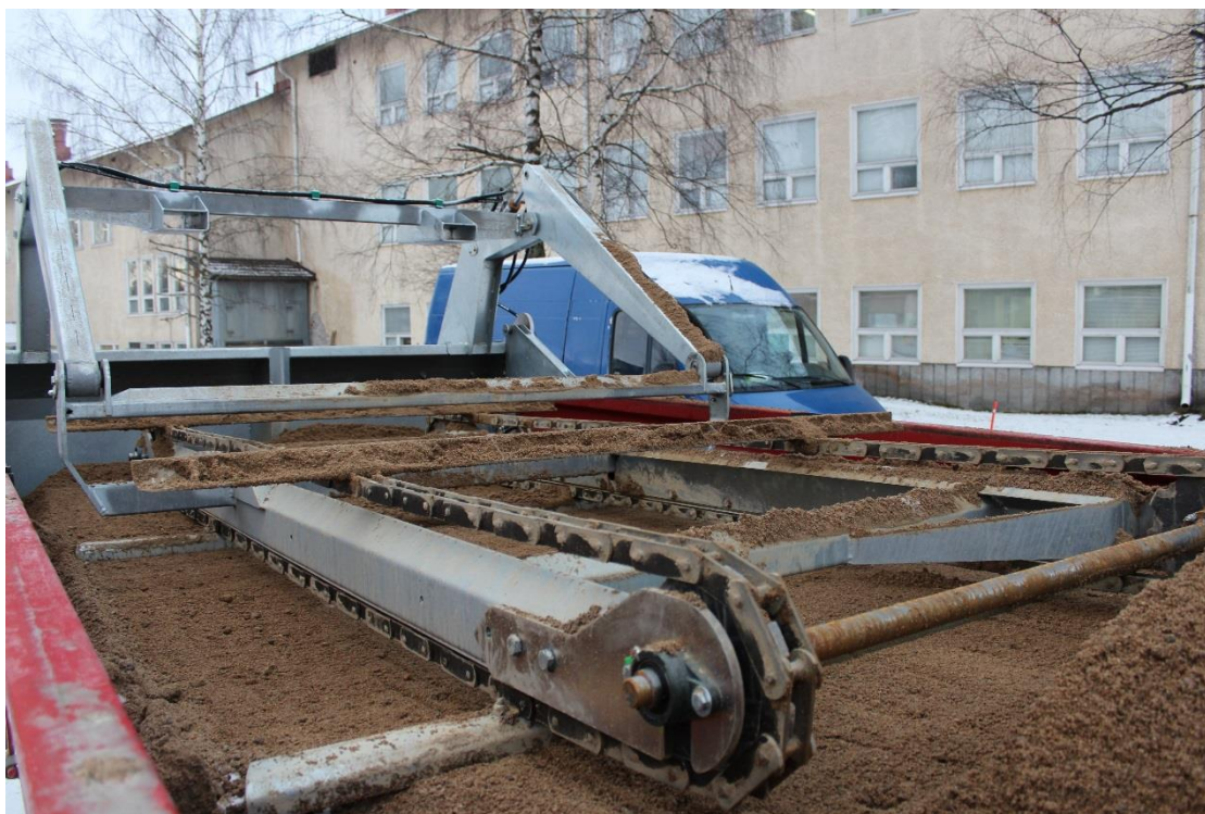
Kuva 2. Finnomec Oy:n SAND-MEC, hiekoittimen lisälaitte. Laitteella hiekoitus voidaan suorittaa nostamatta lavaa, joten esimerkiksi sähkölinjoja ei tarvitse varoa. (Finnomec Oy, verkkosivut)
