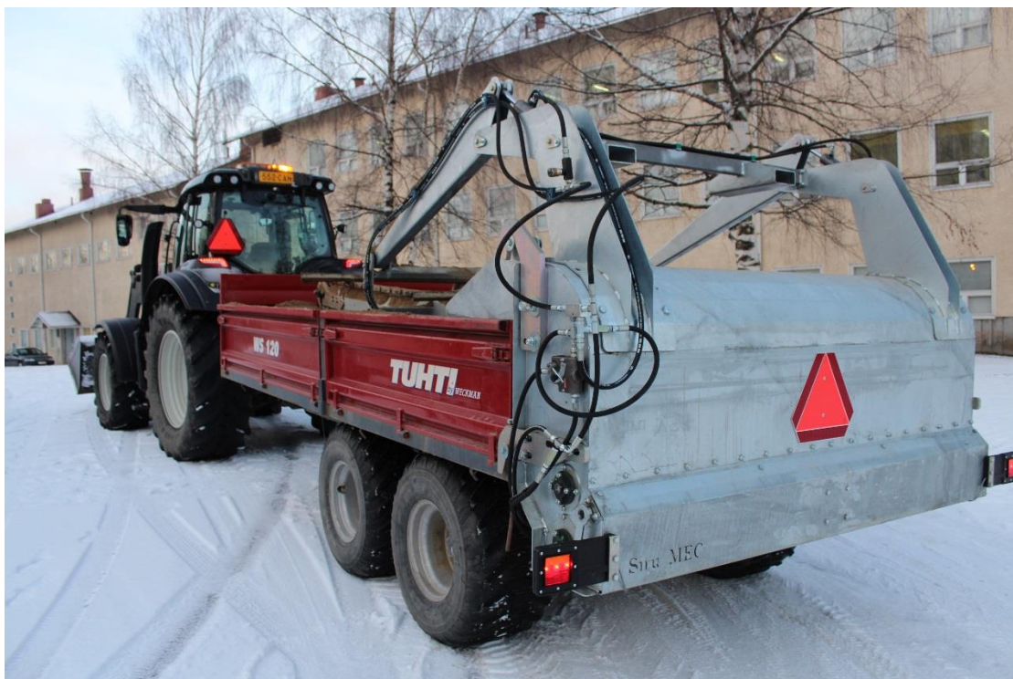
Kuva 1. Finnomec Oy:n SIRU-MEC hiekoitin. Hiekoittimella mahdollista säätää levitettävän hiekan määrää. (Finnomec Oy, verkkosivut)
