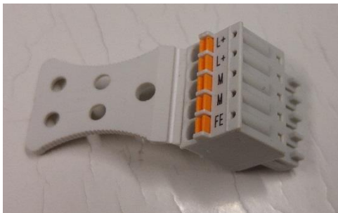
Kuva 10. Terminaalikeskus TB543-eth:n 24 VDC terminaaliliitin irroitettuna.
