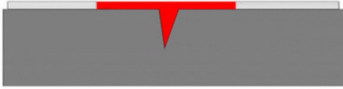
Kuvio 16. Tunkeumaneste nousee pintavirheen kohdalta kehitteen läpi pintaan.
