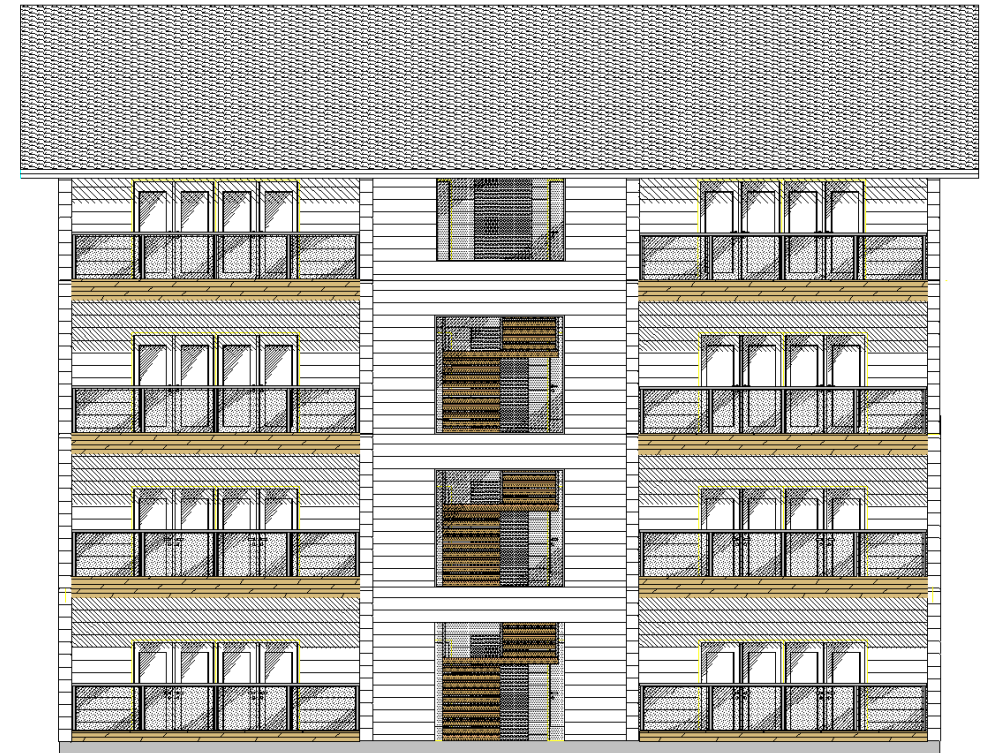
Kuva 3. Log-rise1 julkisivun periaatepiirros, yksirappuisena ja harjakatolla.
