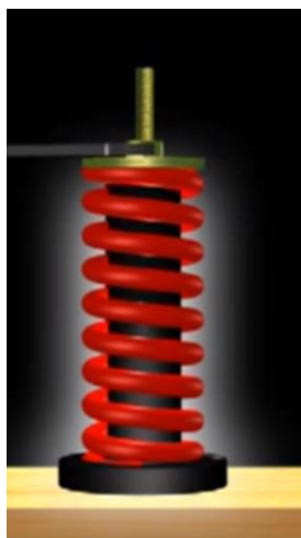
Kuva 15. vasemmalla. Yläpään sylinteriosan toimintamalli. Sisään on rakennettu kiila, joka sallii ainoastaan yhdensuuntaisen liikkeen kierretangolle. Kun sylinteri on asetettu paikalleen, sen päälle asetetaan jousi, joka kiristetään niin, että se varmasti kattaa mahdollisen painuman. Kuva: (True North Log homes)
