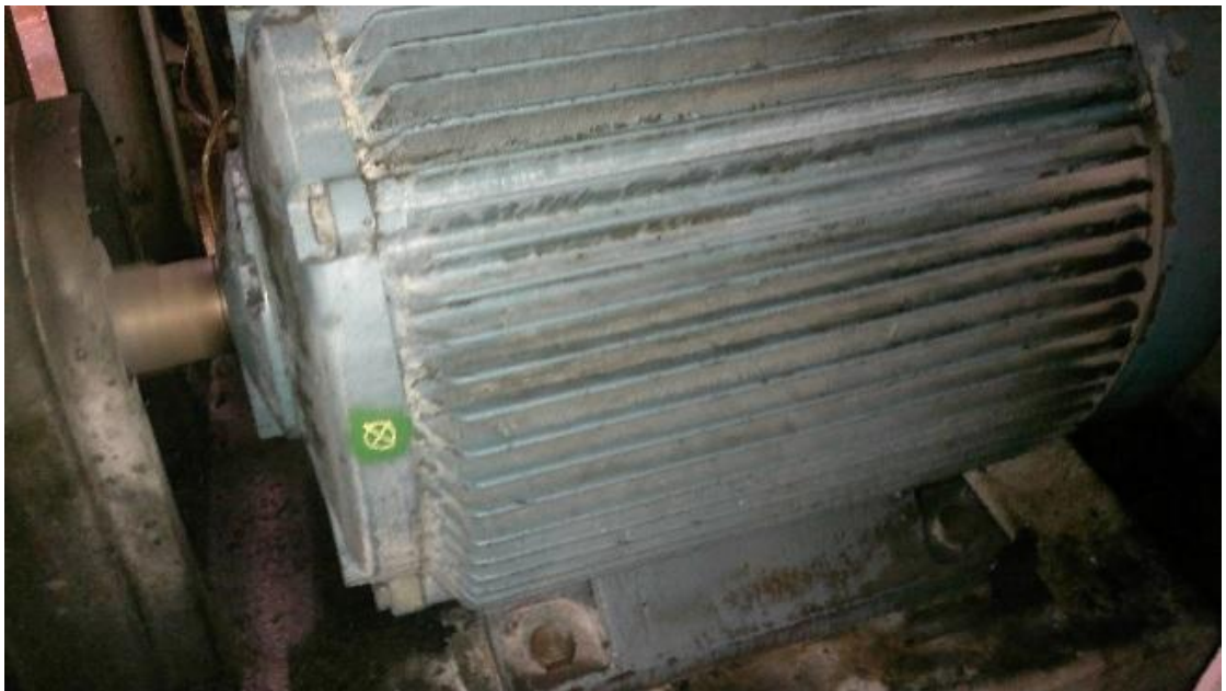
Kuvio 9. Mittauspisteen merkintä moottorin käyttöpuolella
