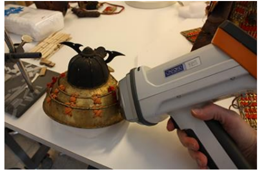
Kuva 21: Oxford instrument x-met 7500 analysaattori
