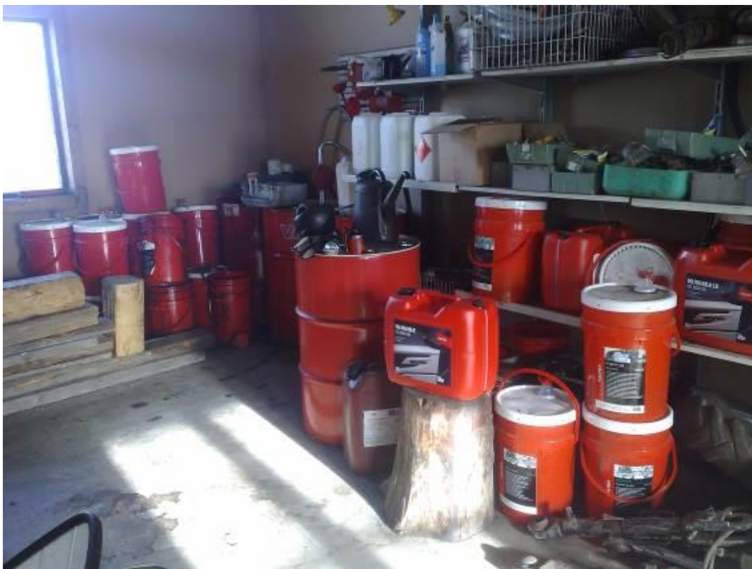
Kuva 17. Öljyt varastoidaan alkuperäisissä pakkauksissaan, jäteöljylle on oma 200 l:n tynnyri kulmassa (Kuva: Siiskonen 2016).
