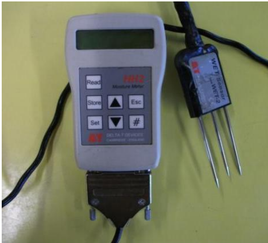
Kuva 4. Delta T kosteusanturi ja HH2-kosteusmittari
