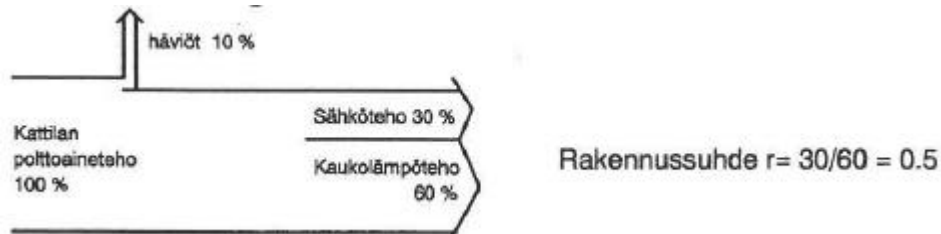
Kuvio 5. Keskikokoisen CHP -voimalaitoksen pelkistetty energiatase (Huhtinen ym. 2012, 12)
