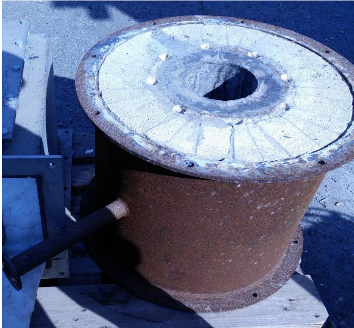
Kuvio 28. Tulipesän ylin osa, jonka kanssa käytetään väliaikaista lämmönvaihdinta
