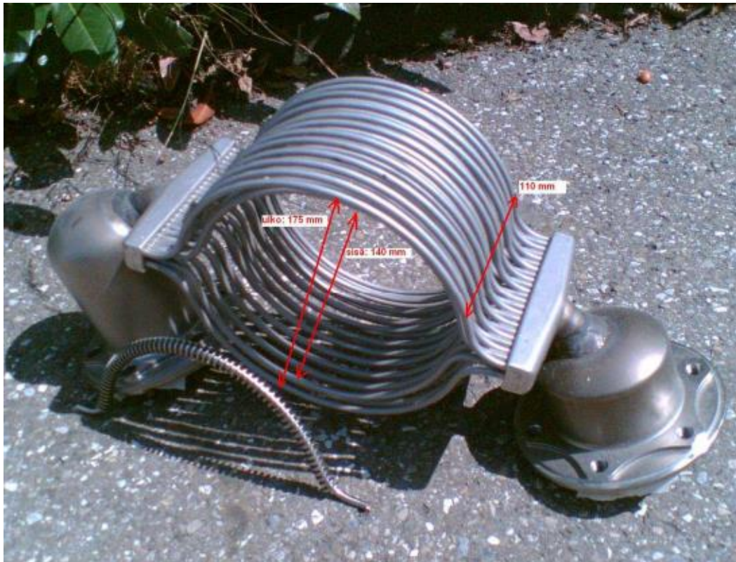
Kuvio 18. Moottorissa oleva lämmönvaihdin. Kuvassa myös rivoitettu putki (Lommi, 2006.)
