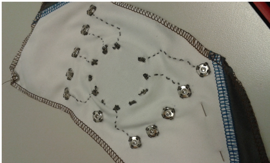
Kuva 2. LilyPad Arduino ommeltuna kankaalle, kankaan toinen puoli.
