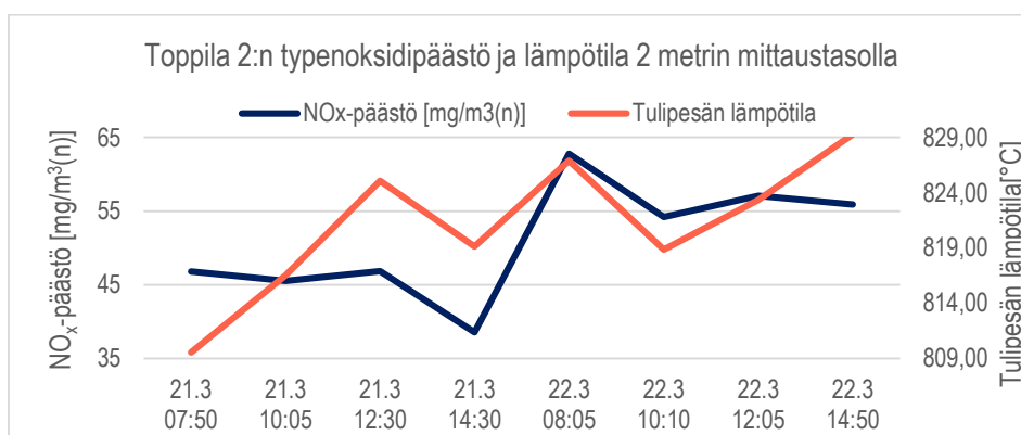
KUVA 53. Toppila 2 -laitosyksikön typenoksidipäästö ja lämpötila kahden metrin mittaustasolla
