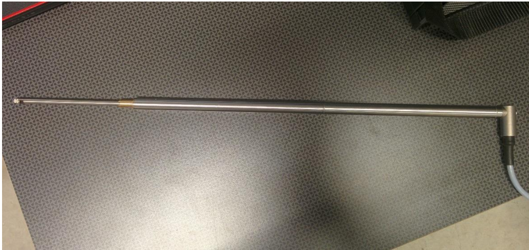
Kuvio 11. HBM:n valmistama induktiivinen siirtymäanturi, jolla voidaan todeta enintään 100:n millimetrin liike.
