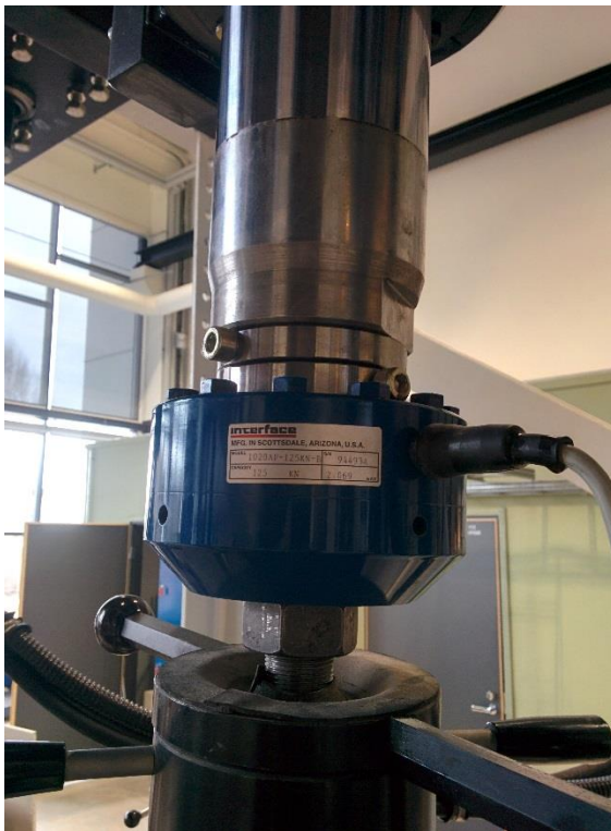
Kuvio 10. Interface-yhtiön valmistama sininen B-tunkin voima-anturi.
