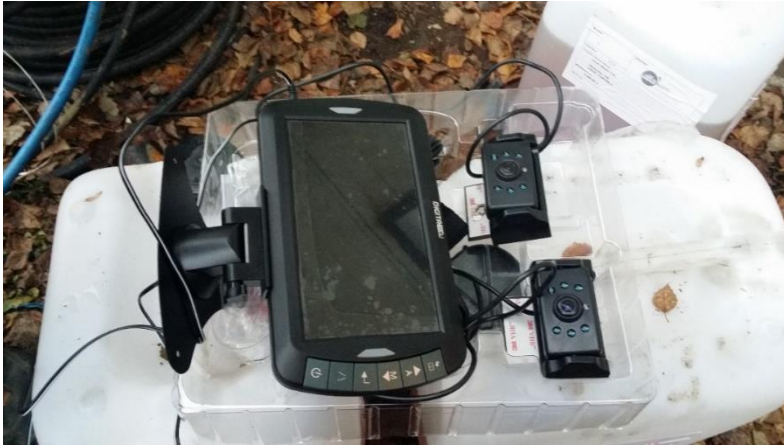
Kuvio 3. Bilteman peruutuskamera paketti, sisältäen näytön ja kaksi kameraa. Kuva: Ahola Noora
