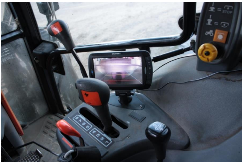
Kuvio 5. Näytön lopullinen sijoituspaikka New Holland Ts115 traktorissa, nopeuden valitsijan vieressä. Kuva: Ahola Noora
