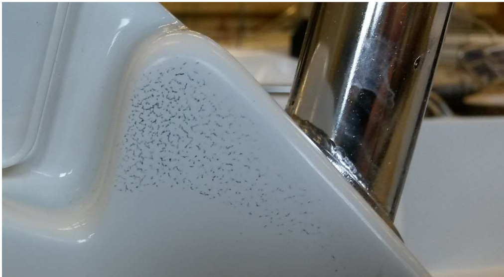
Kuva 4. Liian ohuesta gelcoat-kalvosta johtuvaa lievää poimuttumista
