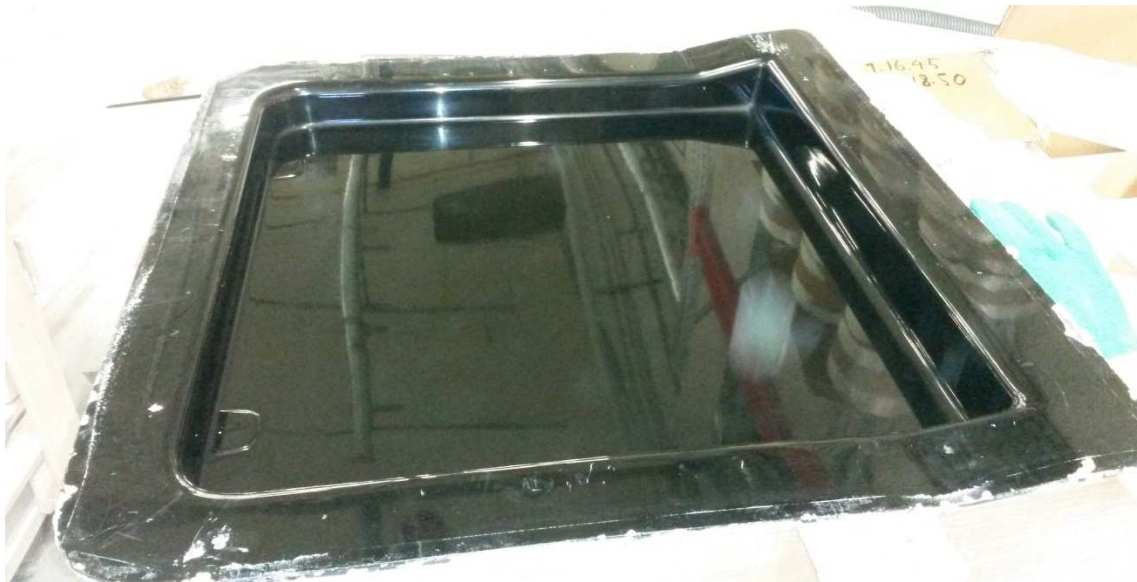
Kuva 3. Luukun kannen muotti, josta rajamallit laminoitiin.
