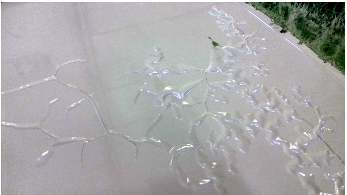
Kuva 5. Poimuttumista, joka johtui toisen gelcoat-kerroksen liian aikaisesta maalaamisesta.
