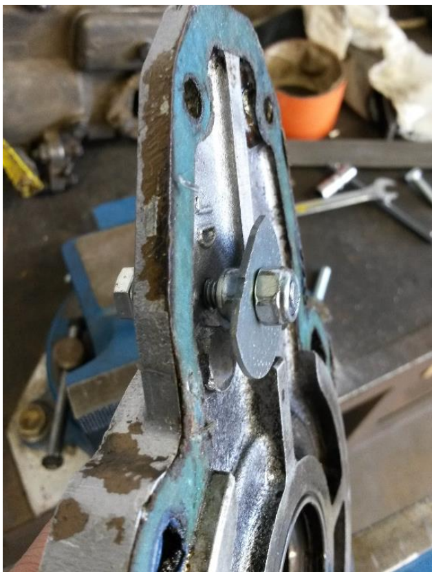
Kuva 8 Ruiskutusmäntiä kiertävän tangon säätö pultti.
