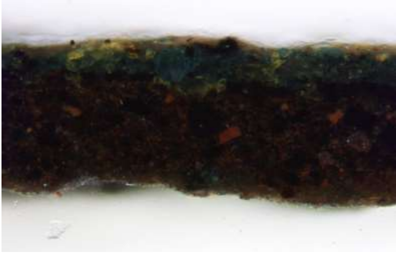
Kuva 24. Näytteessä veistoksen takapuolen päällemaalatulta alueelta erottuu näkyvässä valossa paksu ruskea pohjakerros ja ohut vihreä pintakerros, jossa on seassa keltaista.
