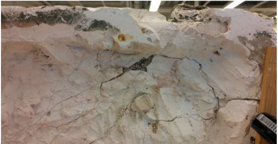
Kuva 29. Jalustan keskiosan ainevahvuus oli ohut; vauriot vaativat liimausta ja täydennystä.
