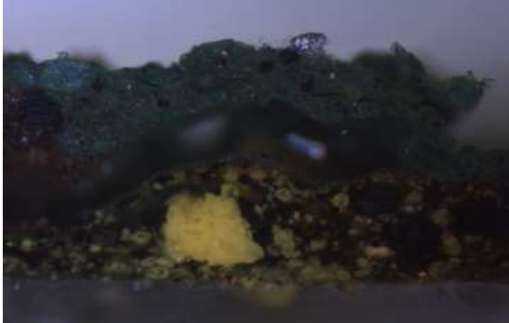
Kuva 23. Näytteessä takapuolen tummanvihreältä alueelta näkyy pinta- ja pohjakerrosten irtoaminen toisistaan. 200-kertainen suurennos.
