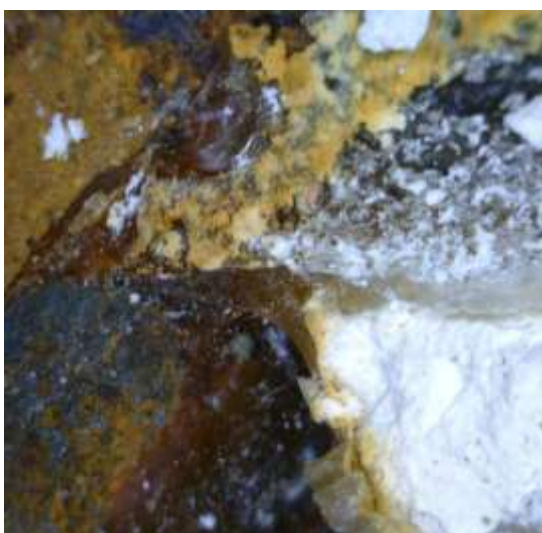
Kuva 14. Ruosteinen rauta värjää niin kipsin kuin liimankin. Dino-Lite Pro -digitaalimikroskooppikuva Nuijamiehen oikean nilkan puutoskohdasta.
