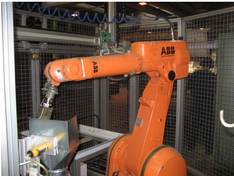
Kuva 6. ABB:n robotti IRB 2400 sekä Atlas Copcon viilauskone.
