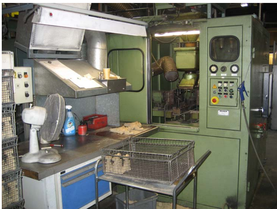
Kuva 2. Keernojen valmistaminen manuaalipaikassa.
