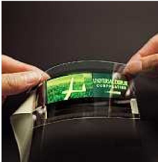
Kuva 11. OLED-näyttö (Sonyn prototyyppi)
