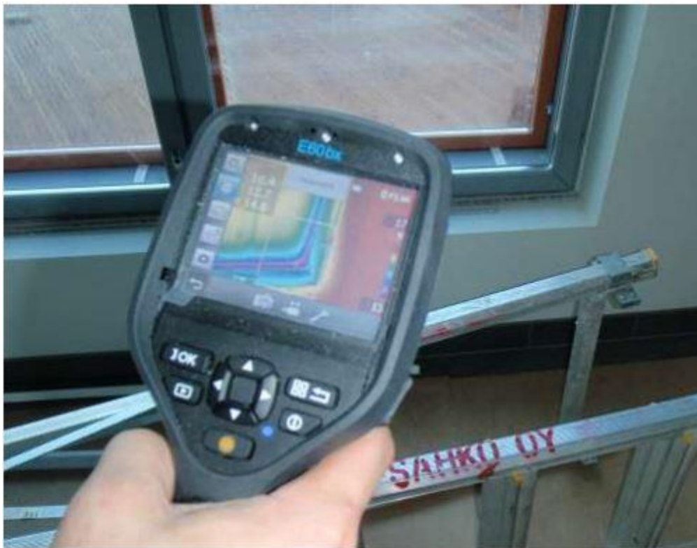
KUVA 1. Ikkunan lämpökamerakuvaus (Paloniitty Oy, lämpökuvaus liite)
