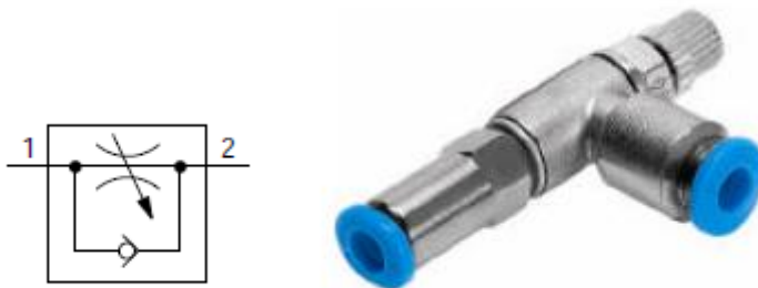
KUVA 5. Vastusvastaventtiili ja sen piirrosmerkki. (Festo Didactic 2005.)
