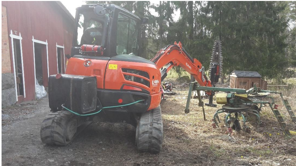
Kuva 14. Telakaivinkone Mensen raivauspäällä. Kuvassa näkyy tehoaineen säiliö ja letku, jota pitkin aine menee raivauspään terälle. Huomioitavaa kuvassa on myös T:n muotoinen tuki, johon raivauspää nojaa.
