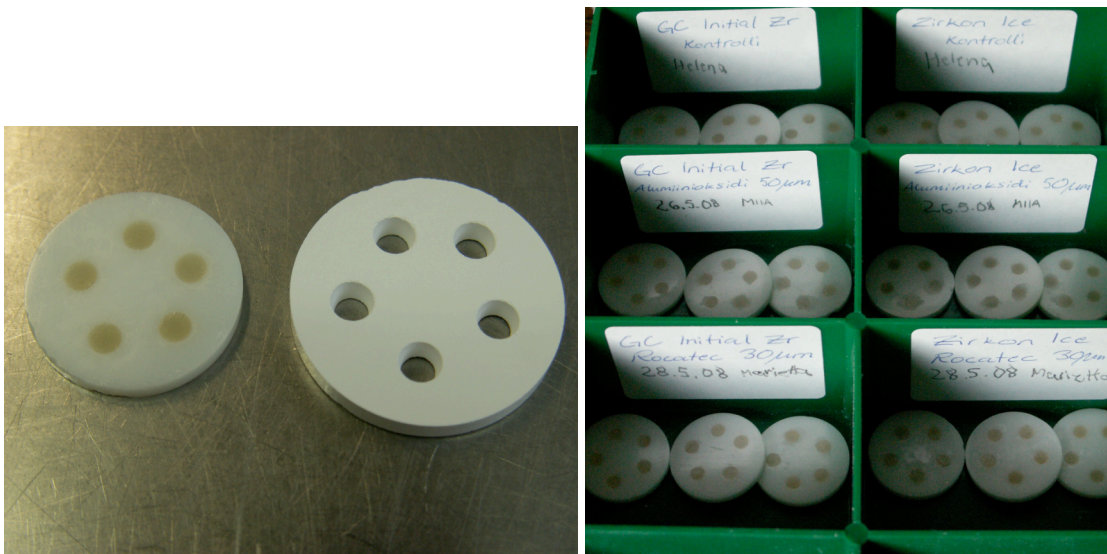
KUVIO 28. Zirconiakiekot, posliinitäytteellä. Reiät, joihin posliini on kerrostettu, ovat katkaistun, suoran ympyräkartion muotoisia. Sivukaltevuus on 8,5°.
