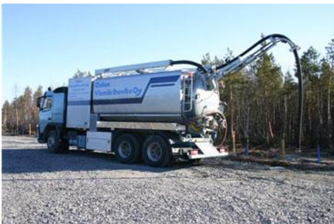
KUVA 2. Korkeapaine huuhtelu/imuauto (Oulun Viemärihuolto Oy)
