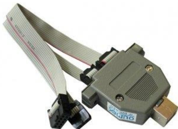
Kuva 7. Lopulliseen ohjelmointiin käytetty Olimex AVR-ISP500 -ohjelmointilaitte [29].
