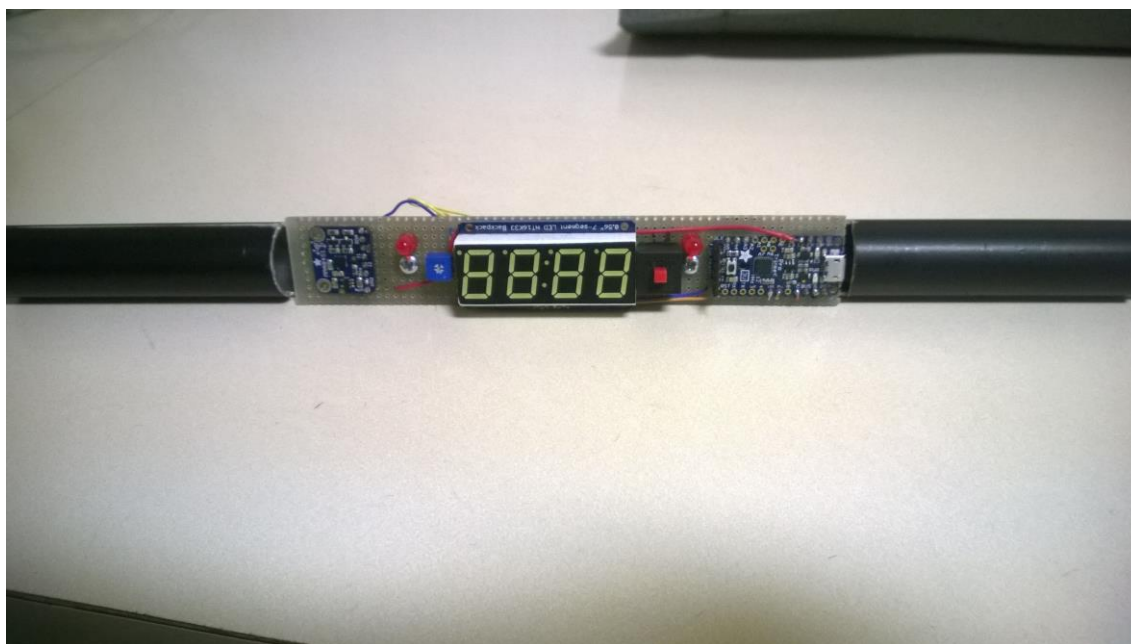
Kuva 3. Ensimmäinen prototyyppiohjain rakennettuna koekytkentäalustalle.
