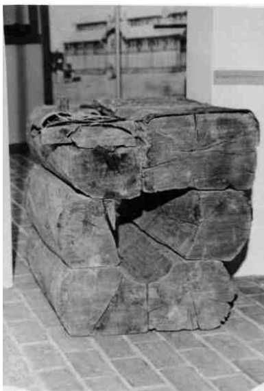
Kuva 1: Pala hirsirakenteista, tuohipäällysteistä viemäriputkea, joka on löydetty Niskakadun saneerauksen yhteydessä. (Pohjois-Karjalan museon valokuvakokoelma 2015)
