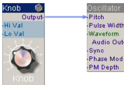
Kuva13. Kontrollijännite saadaan potentiometrillä.
