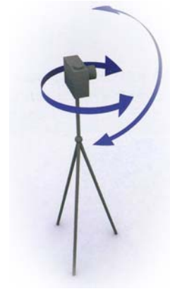
Kuva 5. Kameran panorointi ja kallistamien (Bodin, B., Frich, A., Lemoine, A., Noël, C., Popovic, S., Simard, P., Thion, L. & Vidal, G. 2005, 50)
