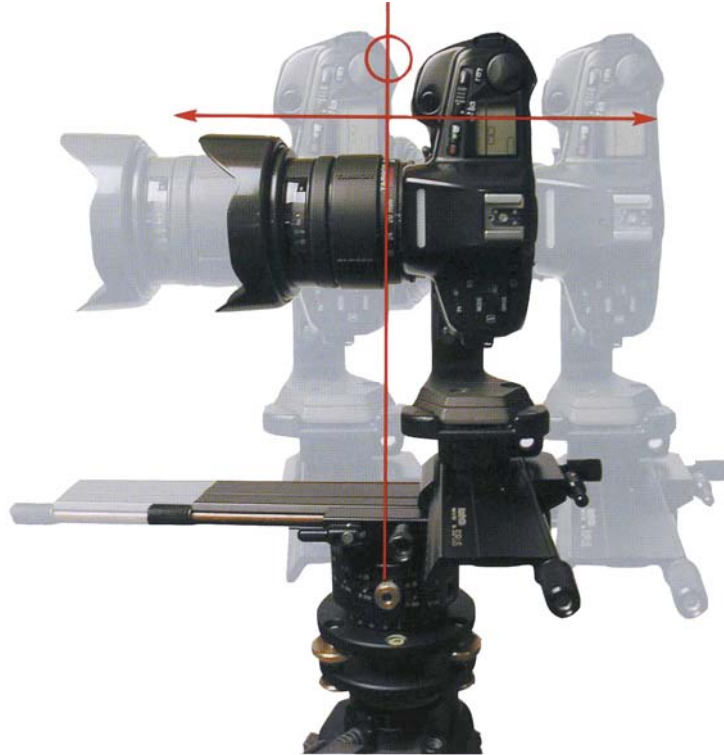
Kuva 14. Kamera asemoidaan perspektiivikeskipisteeseen kokeilemalla parallaksivirhettä. (Andrwes 2003, 40)
