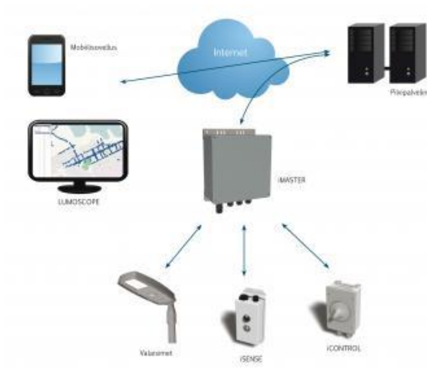
Kuva 5. iLUMNET-järjestelmän arkkitehtuuri (iLUMNET 2016).
