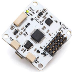
Kuvio 26. OpenPilot CC3D –lennonohjausjärjestelmä
