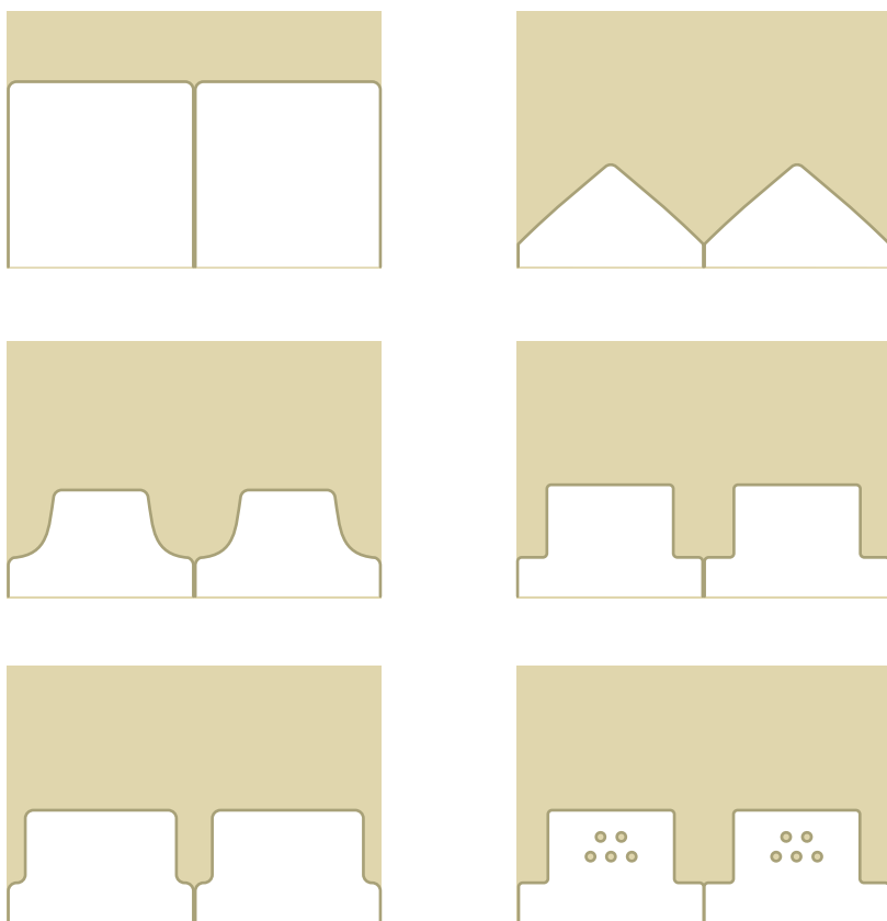
Ritsausnauhan tartuntapään muotoja pinsettiotteelle 1:2.
