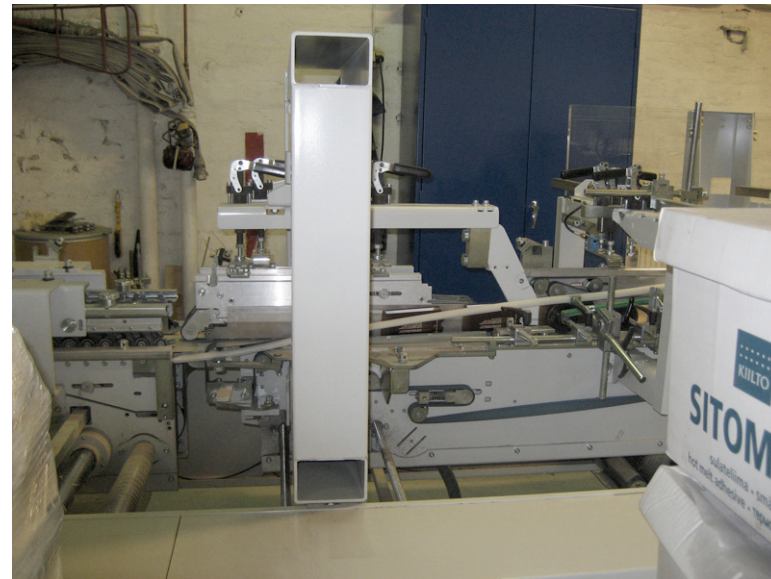
Ikkunanliimakone (Pyrollpack Oy, Lahden tehdas 2008).
