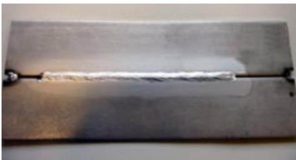
KUVA 3 Peittauksen vaikutus hitsiin (Esab, 2004)
