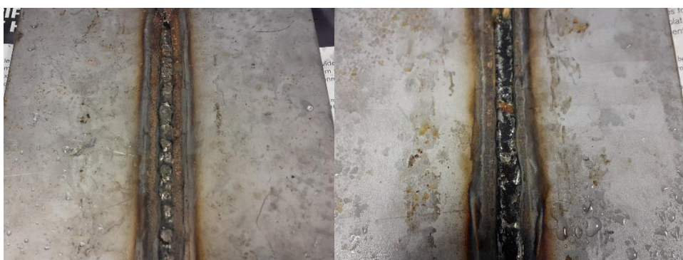
KUVA 34 Haponkestävän juurenpuoli (vas.) ja super duplexin juurenpuoli (oik.) (Nuutinen, 2016)
