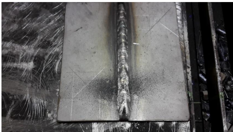
KUVA 15 Metallipöly ja naarmut (Nuutinen, 2016)
