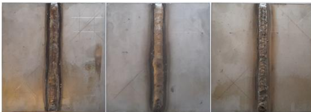
KUVA 38 Peittaamattomat kappaleet hiomapölyn poiston jälkeen (vas.) 316L, keskellä duplex ja (oik.) super duplex
