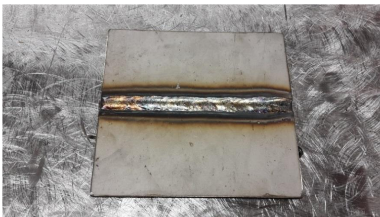
KUVA 11 Duplex-teräksen hitsi (Nuutinen, 2016)
