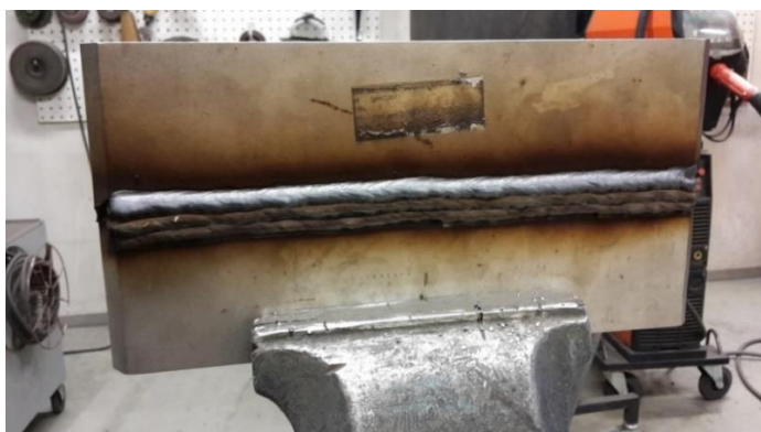
KUVA 13 310L-teräksen valmis hitsi (Nuutinen, 2016)
