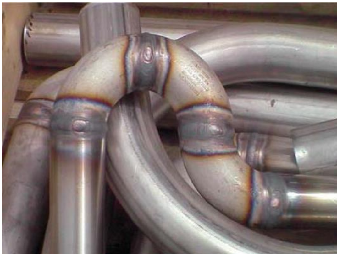
KUVA 2 Lämpöväri vyöhyke putkihitsissä (EuroInox, 2004)
