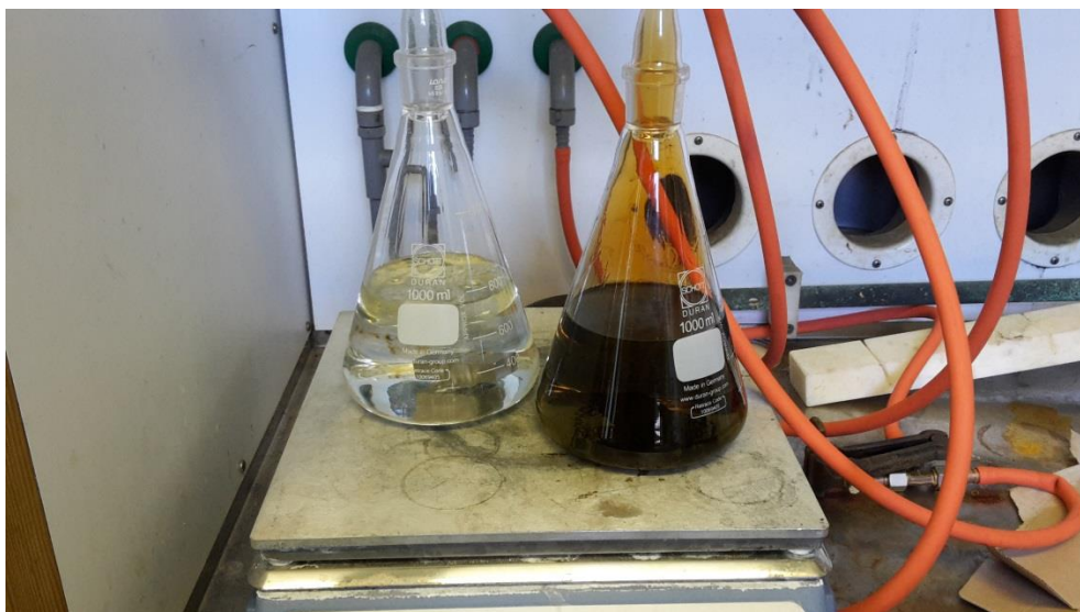
KUVA 44 Typpihapon väriero peittaamattomien kappaleiden kiehuessa kolmannen koejakson lopulla 310L (vas.) ja 321 (oik.) (Nuutinen, 2016)
