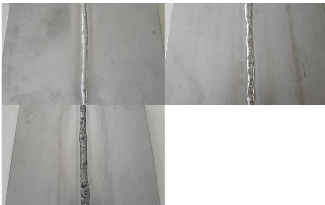
KUVA 37 Peitatut hitsit juurenpuolelta (vas. yläpuoli) haponkestävä, (oik. yläpuoli) duplex ja (vas. alapuoli) super duplex (Nuutinen, 2016)
