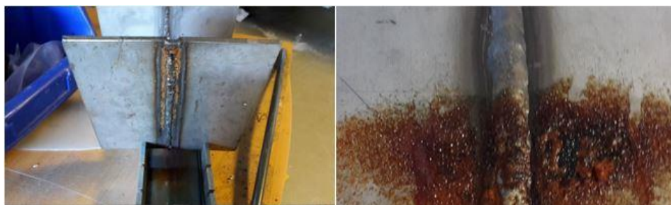
KUVA 33 Haponkestävän ruostunut juuri (vas.) ja duplex kappaleen pintaan ruostunut hiomapöly (oik.) neljän vrk. sumutuksen jälkeen (Nuutinen, 2016)
