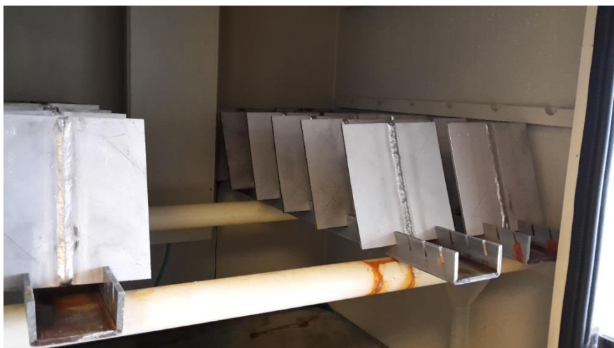
KUVA 30 Koekappaleet etikkahapposuolasumukaapissa (Nuutinen, 2016)
