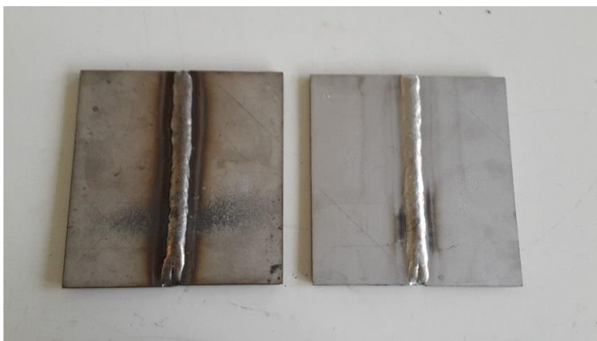
KUVA 29 EN 1.4362 duplex koekappaleet (vas.) peittamaton ja (oik.) peitattu (Nuutinen, 2016)
