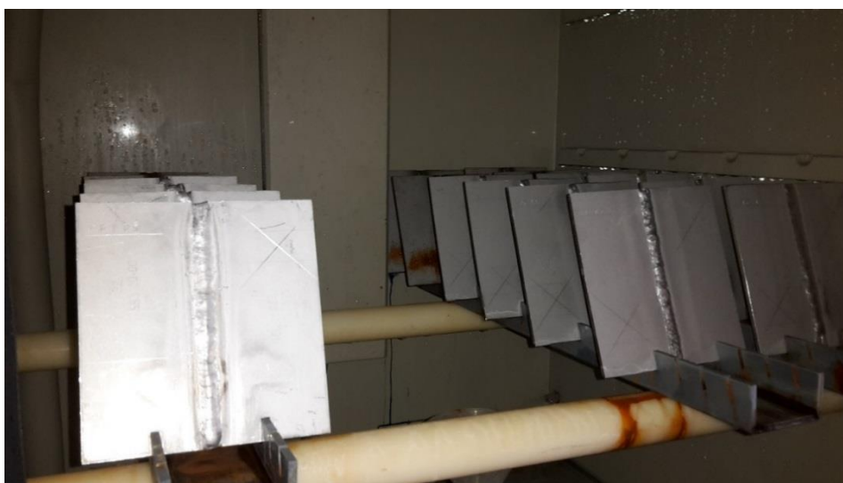
KUVA 31 Koekappaleet 4 vrk. sumutuksen jälkeen (vas.) haponkestävä, seuraavana super duplex ja (oik. reunassa) duplex (Nuutinen, 2016)
