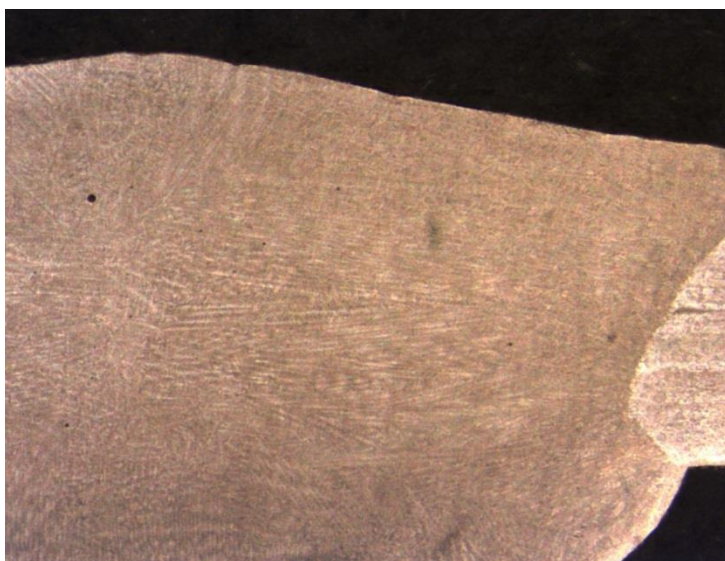
KUVA 25 Super duplex -teräksen huokoset (Nuutinen, 2016)
