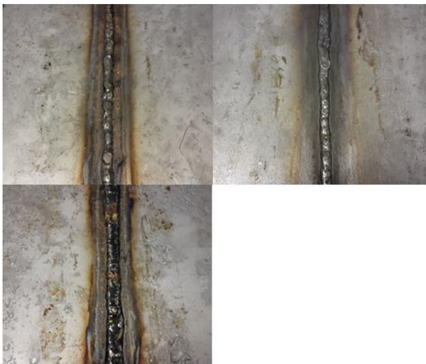
KUVA 36 Juurenpuolen hitsit (vas. yläpuoli) haponkestävä, (oik. yläpuoli) duplex ja (vas. alapuoli) super duplex (Nuutinen, 2016)
